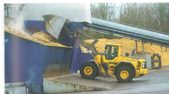
Ein Radlader befördert die Hackschnitzel in den Schüttbunker.
